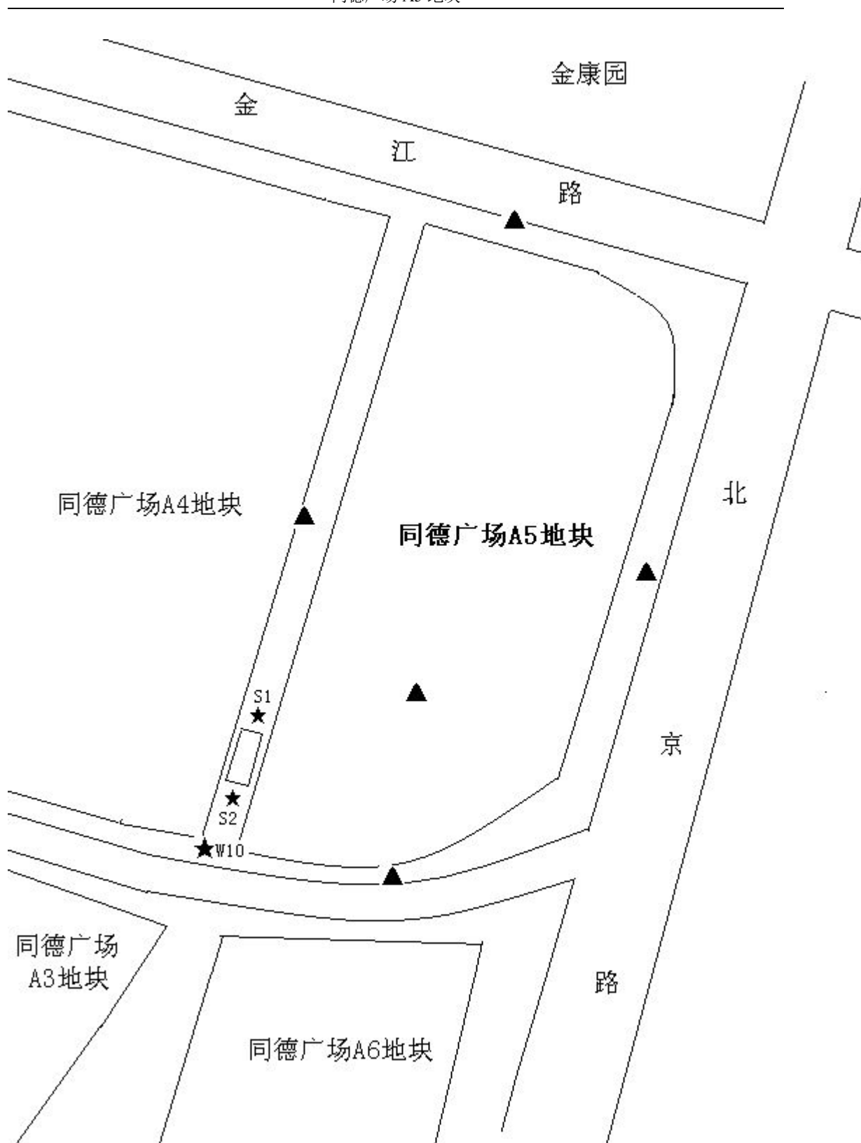
图 6-1 废水、噪声监测布点 (注：★为废水采样点，▲为噪声监测点)
